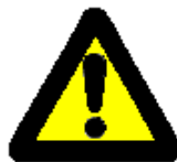
Peligro en general
